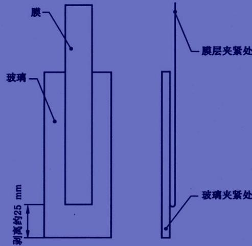
图6 试样剥离示意图
