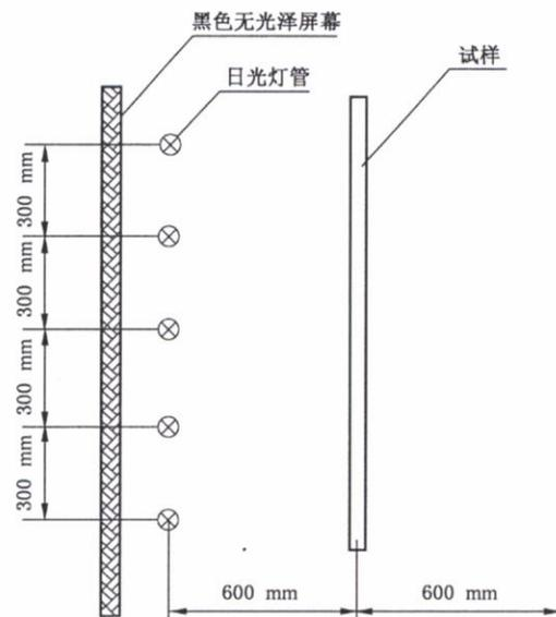
图1 尘点、斑点、膜面划伤的测定示意图
